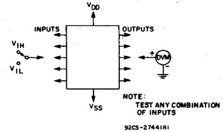
Fig. 16 - Input voltage.
