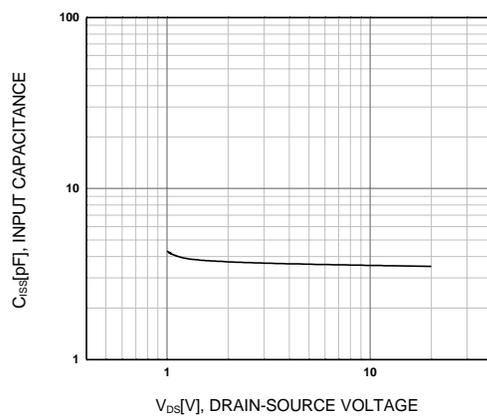
Figure 6.  $C_{iss}$ - $V_{DS}$
