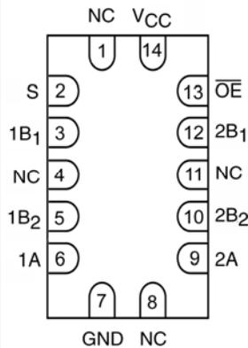
Figure 3. DQFN (Top Through View)
