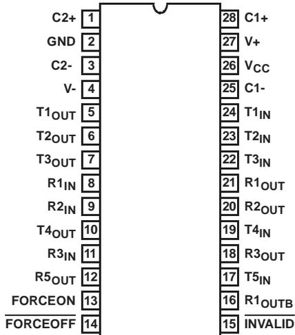
ICL3244 (SOIC, SSOP, TSSOP)
