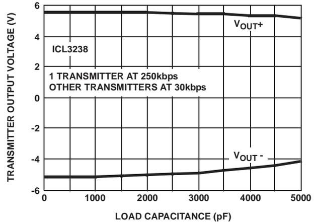
FIGURE 16. TRANSMITTER OUTPUT VOLTAGE vs LOAD CAPACITANCE
