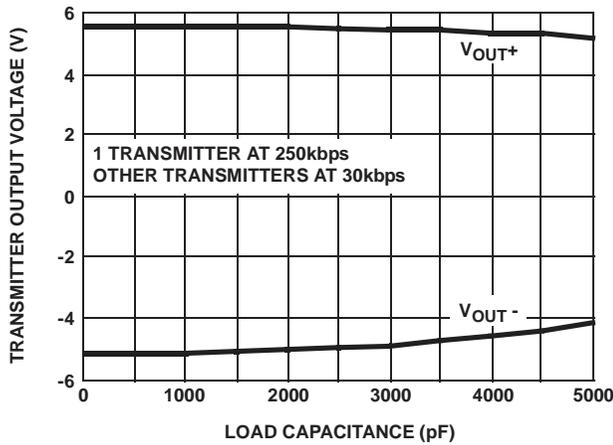
FIGURE 14. TRANSMITTER OUTPUT VOLTAGE vs LOAD CAPACITANCE
