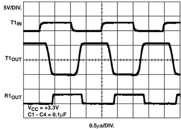
FIGURE 14. LOOPBACK TEST AT 1Mbps ( $C_L = 250\text{pF}$ )
