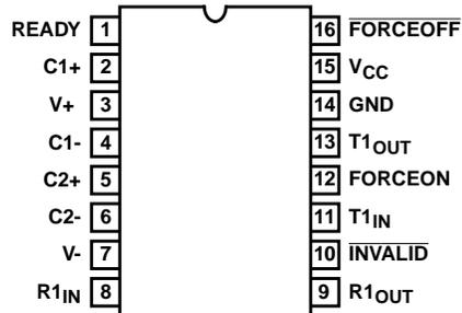
ICL3245 (SOIC, SSOP, TSSOP)
