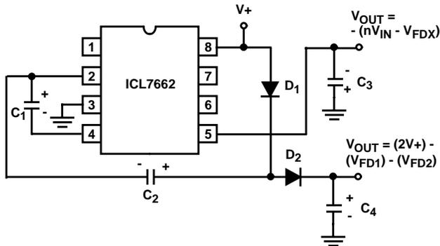
FIGURE 23. COMBINED NEGATIVE CONVERTER AND POSITIVE DOUBLER
