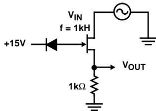
FIGURE 2. ANALOG INPUT VOLTAGE RANGE TEST CIRCUIT
