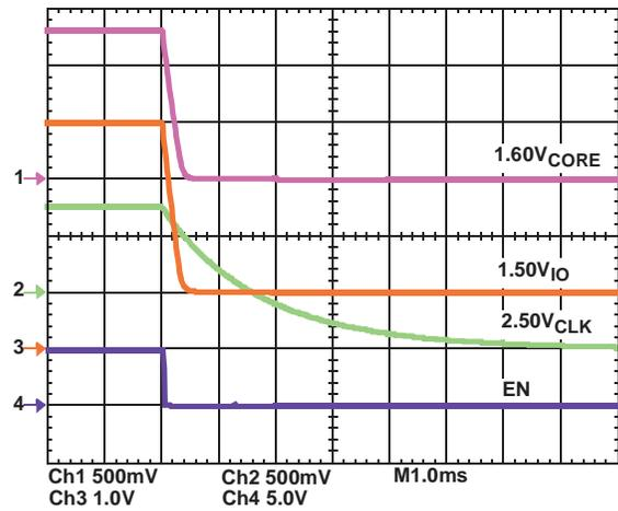
FIGURE 11. SHUTDOWN WAVEFORMS
