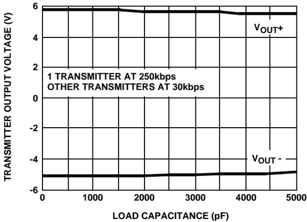
FIGURE 12. TRANSMITTER OUTPUT VOLTAGE vs LOAD CAPACITANCE
