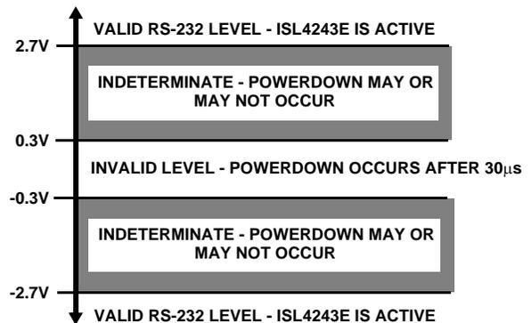
FIGURE 6. DEFINITION OF VALID RS-232 RECEIVER LEVELS
