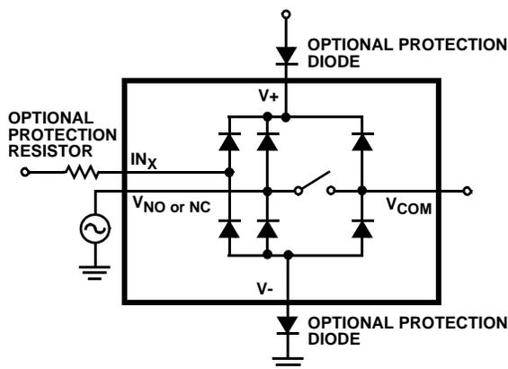
FIGURE 8. OVERVOLTAGE PROTECTION
