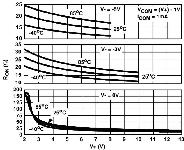
FIGURE 9. ON RESISTANCE vs POSITIVE SUPPLY VOLTAGE
