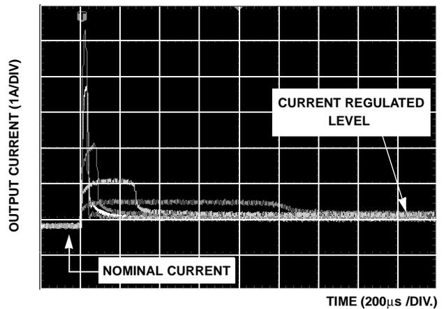
FIGURE 7. OC TO CR SETTLING TIME WAVEFORMS
