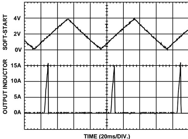
FIGURE 4. OVERCURRENT OPERATION
