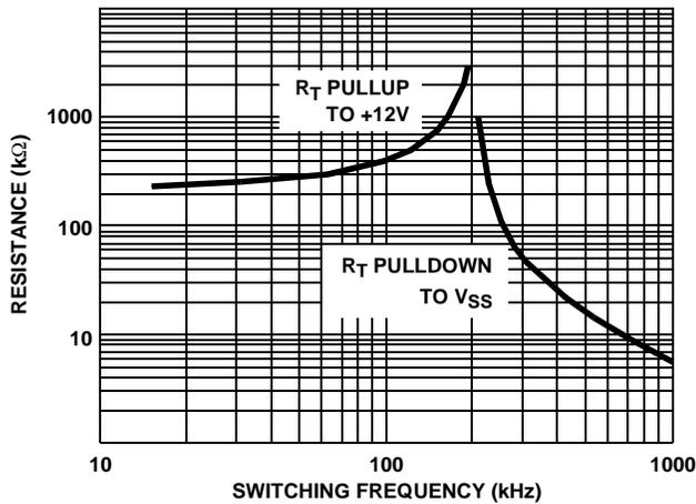
FIGURE 1. R<sub>T</sub> RESISTANCE vs FREQUENCY
