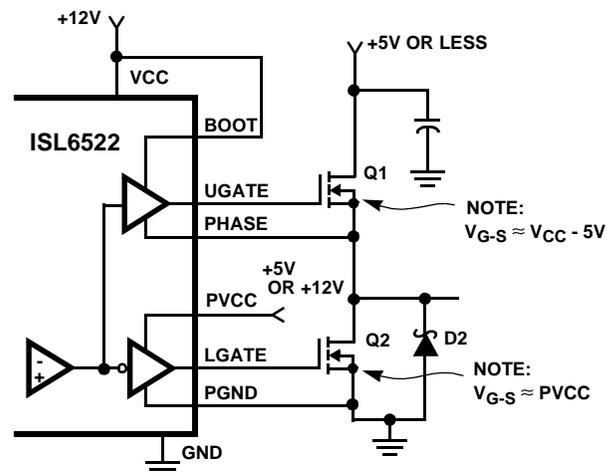
FIGURE 10. UPPER GATE DRIVE - DIRECT  $V_{\text{CC}}$  DRIVE OPTION
