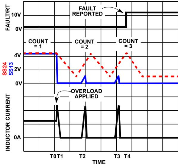
FIGURE 8. OVER-CURRENT OPERATION
