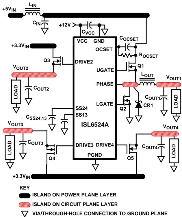
FIGURE 10. PRINTED CIRCUIT BOARD POWER PLANES AND ISLANDS
