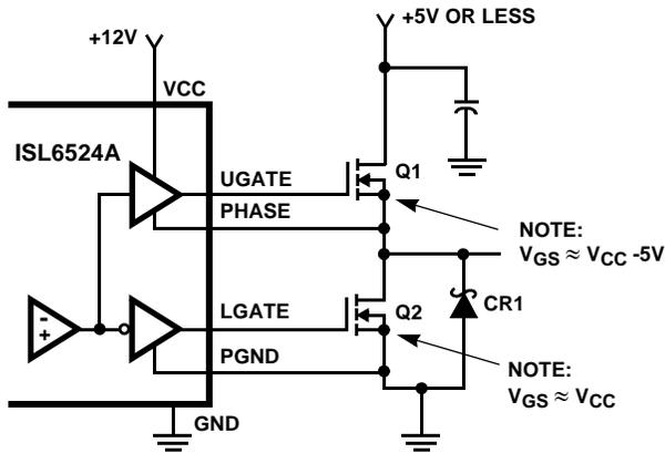
FIGURE 13. UPPER GATE DRIVE - DIRECT V<sub>CC</sub> DRIVE
