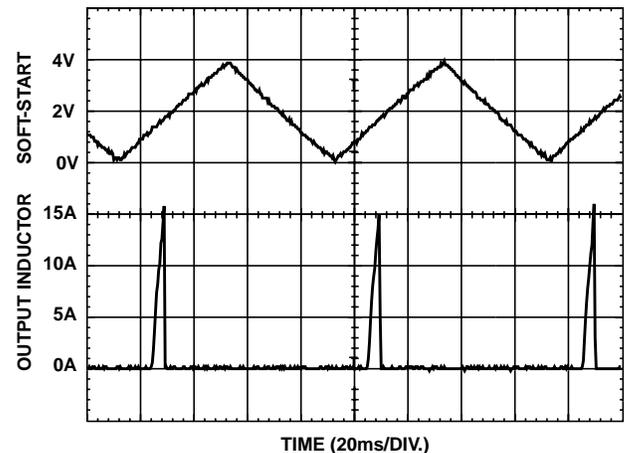
FIGURE 4. OVER-CURRENT OPERATION
