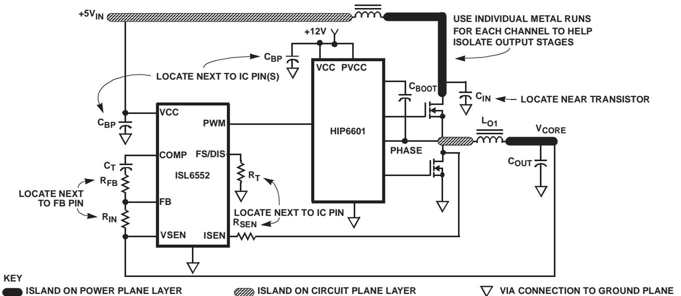
FIGURE 12. PRINTED CIRCUIT BOARD POWER PLANES AND ISLANDS
