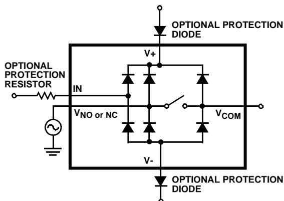
FIGURE 6. OVERVOLTAGE PROTECTION
