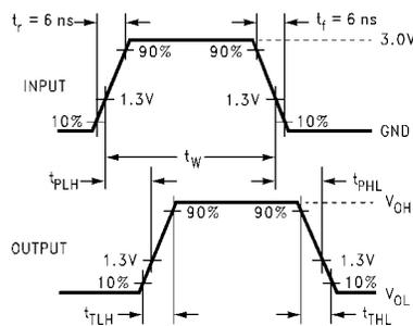
**FIGURE 3. AC Waveforms**
