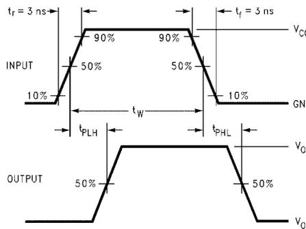
**FIGURE 3. AC Waveforms**
