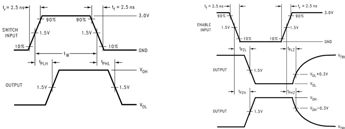
**FIGURE 2. AC Waveforms**
