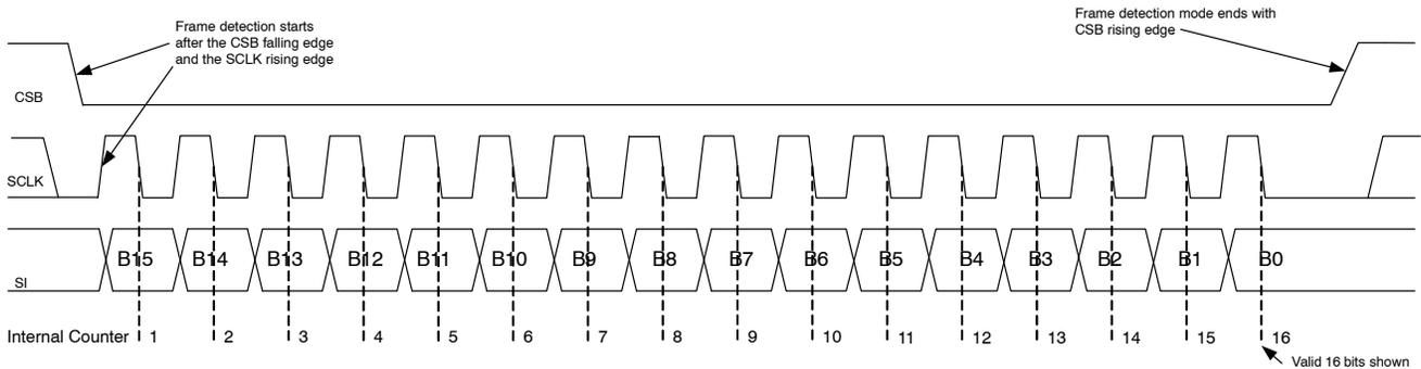
**Figure 28. Frame Detection**
