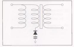
Fig. 3 : CLAMPING DIODE.
