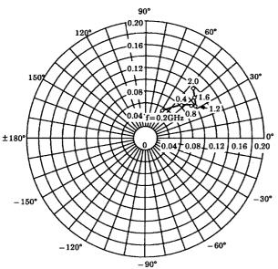
S<sub>22e</sub> V<sub>CE</sub>=10V I<sub>C</sub>=5mA T<sub>a</sub>=25°C (Unit: Ω)
