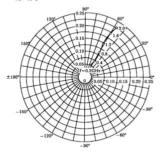
$S_{22e}$   $V_{CE}=5V$   $I_{C}=5mA$   $T_{a}=25^{\circ}C$
