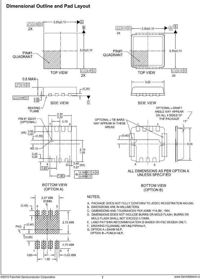
FDMC7692S N-Channel Power Trench<sup>®</sup> SyncFET<sup>TM</sup>
