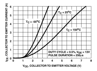
FIGURE 5. COLLECTOR TO EMITTER ON-STATE VOLTAGE
