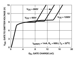
FIGURE 14. GATE CHARGE WAVEFORMS
