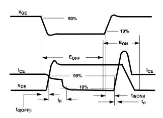
FIGURE 21. SWITCHING TEST WAVEFORMS
