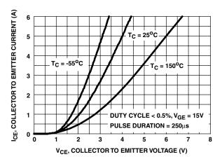
FIGURE 6. COLLECTOR TO EMITTER ON-STATE VOLTAGE
