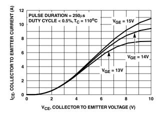
FIGURE 16. COLLECTOR TO EMITTER ON-STATE VOLTAGE
