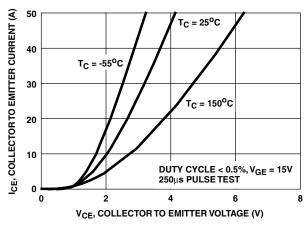
FIGURE 6. COLLECTOR TO EMITTER ON-STATE VOLTAGE
