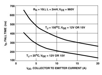
FIGURE 12. FALL vs COLLECTOR TO EMITTER CURRENT
