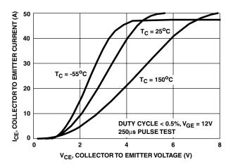
FIGURE 5. COLLECTOR TO EMITTER ON-STATE VOLTAGE
