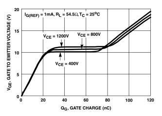
FIGURE 14. GATE CHARGE WAVEFORMS
