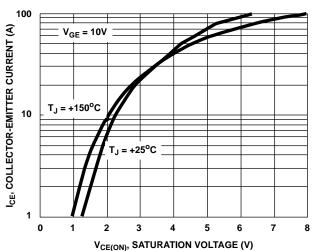
FIGURE 11. COLLECTOR-EMITTER SATURATION VOLTAGE
